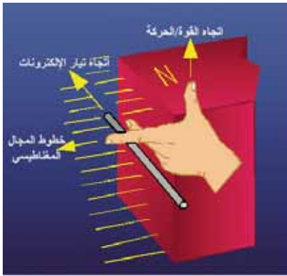
الشكل (١٧): قاعدة اليد اليسرى لتحديد اتجاه القوة المؤثرة على موصل في مجال مغناطيسي
