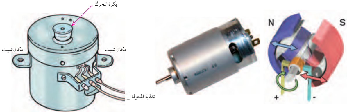
المحرك المستخدم في أجهزة التسجيل.
